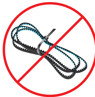
NIET SAMENBINDEN MET KABELBINDERS
